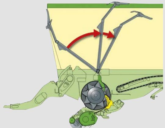
Laderaum frei. Da hierbei der freie Platz über dem Rotor genutzt wird, baut ein RX bei gleichem Ladevolumen deutlich kürzer als vergleichbare Wagen. Während des Entladens kann durch mehrmaliges automatisches Vor- und Zurückschwenken der Stirnwand der Entladevorgang deutlich beschleunigt werden.
